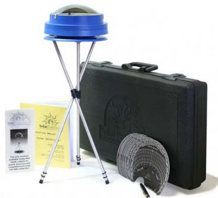
Slika 1: Solar Pathfinder uređaj
